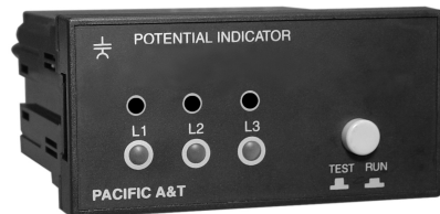
CG6540S 带电指示器 嵌入式安装 开孔尺寸44X92
