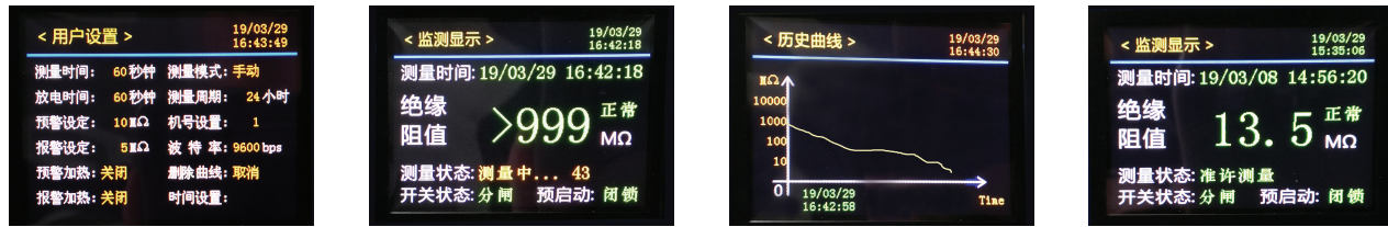
参数设置页面 测量结果显示 自动记录显示历史数据曲线 绝缘阻值过低报警
