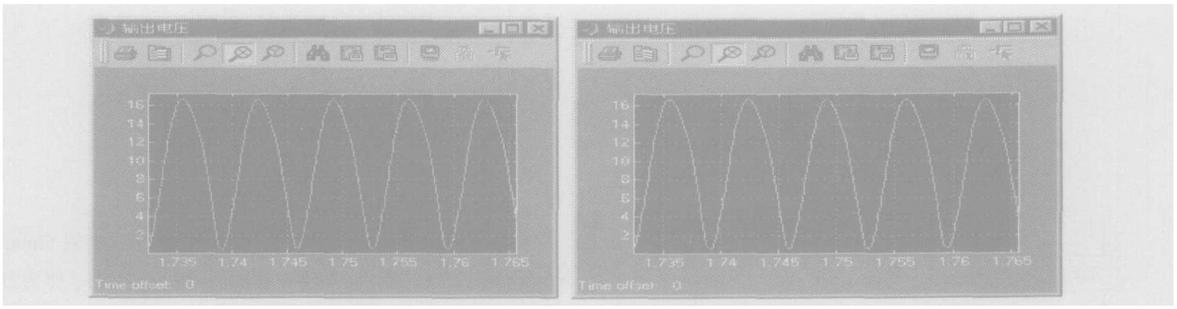
图 6 输出电压和电感电流的波形图 ( $V_s = 30V$ )
