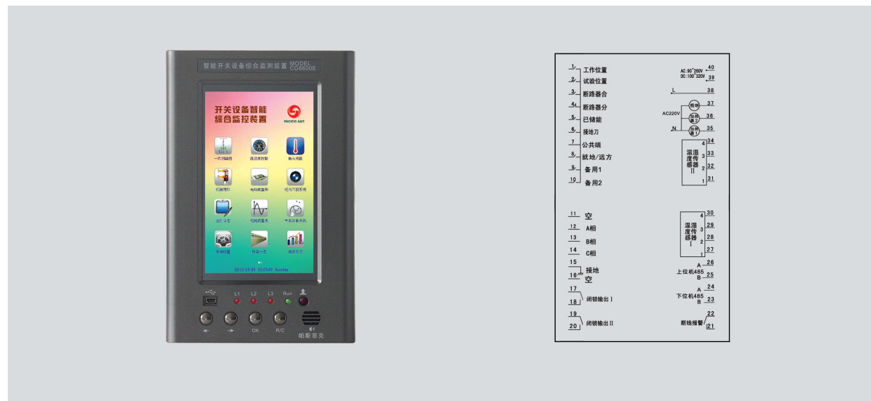
CG6600E的主界面及输入/输出接线图
