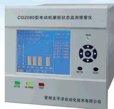
CG2080型仪表专门用于 电动机磨损偏心在线监测
